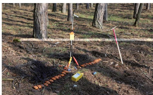
Kabellose Messstation zur Aufzeichnung des reflektierten Signals
